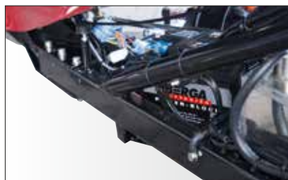
Rahmen: Kunststoffbeschichtet nach Automobilstandard (Salzsprühstest 600 h). Erhöhter Korrosionsschutz durch 4-Phasen-Bearbeitung. Dicke Wandstärken, verwindungssteif und optimale Fahreigenschaften.
