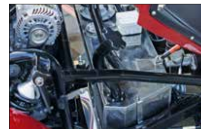
Anbauteile: über 50 neue Edelstahlteile anstatt verzinkter oder beschichteter Teile, wie Edelstahltank, Dehnungsbehälter, Motorhalter, Getriebehälter, Motorverblendung, Kühlerverkleidung, Handbremshebelverkleidung, Luftleitbleche, diverse Kleinteile sowie sämtliche Befestigungsteile.
