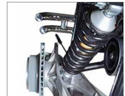
Fahrwerk: Aluminium Schräglenker und verstellbares Bilstein Gewindefahrwerk mit drei wählbaren Federn: weich, normal oder hart.
