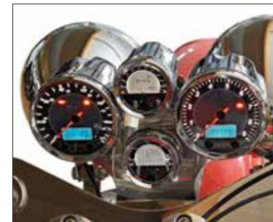
Modernes Instrumentencockpit: zeigt alle benötigten Informationen digital an, mit Diodentechnik.
