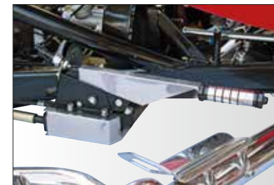
Handbremse: Edelstahlabdeckung und Edelstahlgriff.
