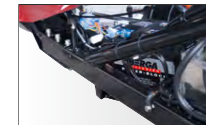
Rahmen: Kunststoffbeschichtet nach Automobilstandard (Salzsprühtest 600 h). Erhöhter Korrosionsschutz durch 4-Phasen-Bearbeitung. Dicke Wandstärken, verwindungssteif und optimale Fahreigenschaften.
