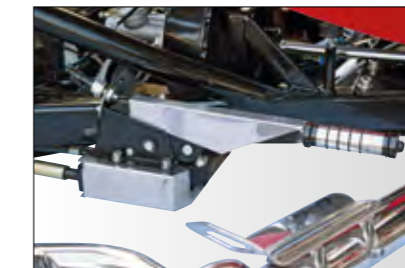
Handbremse: Edelstahlabdeckung und Edelstahlgriff.
