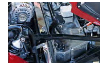
Anbauteile: über 50 neue Edelstahlteile anstatt verzinkter oder beschichteter Teile, wie Edelstahltank, Dehnungsbehälter, Motorhalter, Getriebehalter, Motorverblendung, Kühlerverkleidung, Handbremshebelverkleidung, Luftleitbleche, diverse Kleinteile sowie sämtliche Befestigungsteile.
